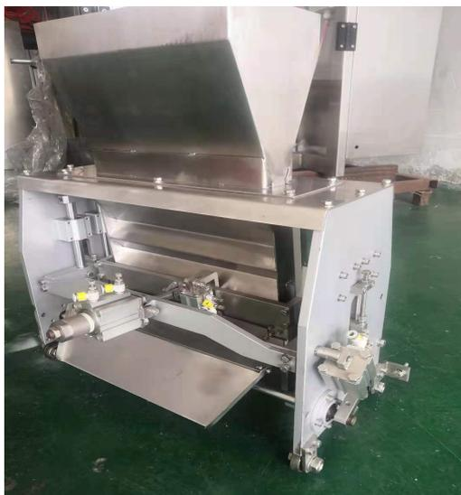
Формирователь пакетиков, система запечатывания и резки (две аналогичные системы в одной машине)
